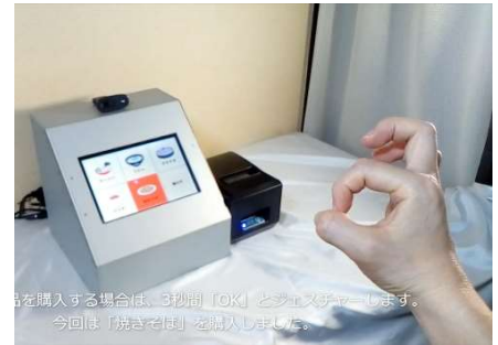
AIカメラが手の位置とジェスチャーを認識し画面を操作します
