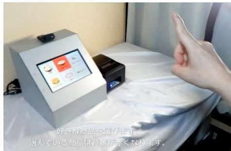
AIカメラが手の位置とジェスチャーを認識し画面を操作します
